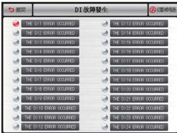
【图8-10】DI故障显示方式为文字形式的画面
