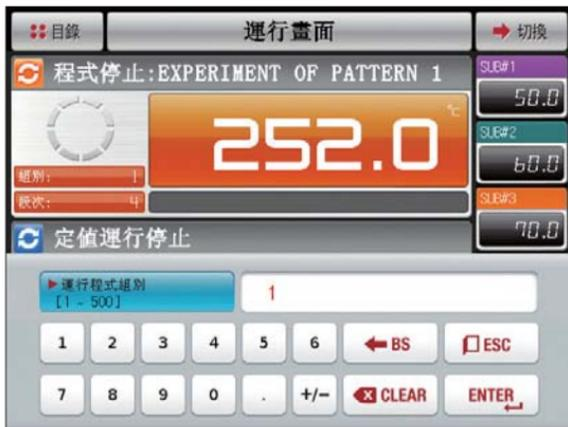
[图4-27]程式/定值运行停止画面中要运行的程式组别设定输入键画面(非同步运行)
