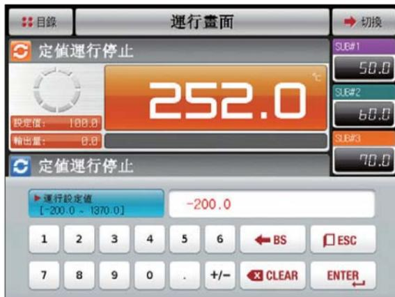
[图4-3]设定将运行的目标值的输入键画面
