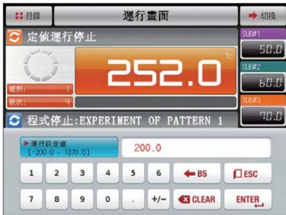
[图4-29]在定值/程式运行定值画面中要运行的定值目标值设定输入键画面(同步运行)
