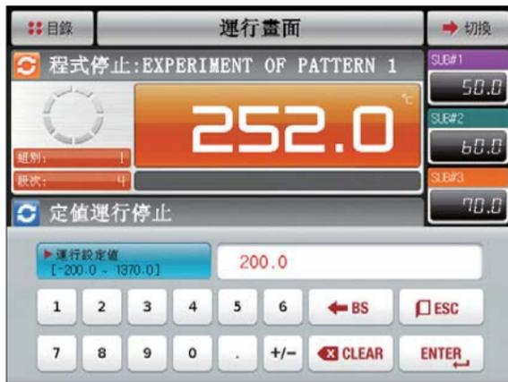
[图4-28]程式/定值运行定值画面中要运行的定值目标值设定输入键画面(非同步运行)
