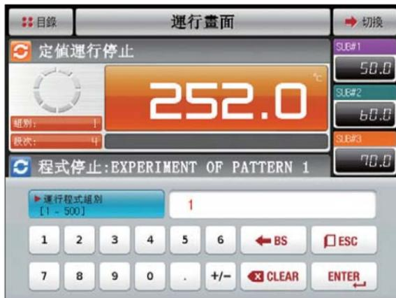
[图4-30]定值/程式运行定值画面中要进行程式运行的程式组别设定输入键画面(同步运行)
