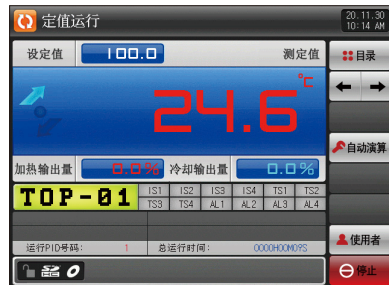
[图4-35]定值运行第一运行画面(加热·冷却)
