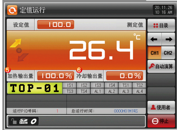
[图4-8]定值运行第2运行画面(加热・冷却)
