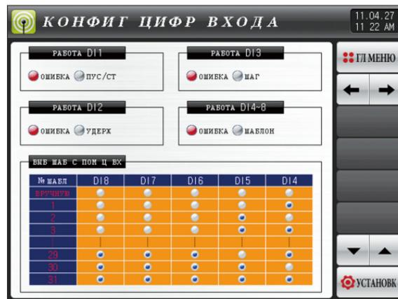
[Рис. 12-7] Экран настройки функций цифрового входа
