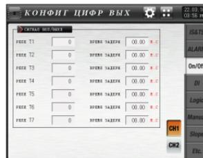
[Рис. 11-4] Экран настройки реле сигнала ВКЛ/ВЫКЛ темп
