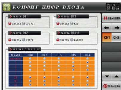
[Рис. 12-2] Экран №2 настройки функций цифрового входа (Канал 1)
