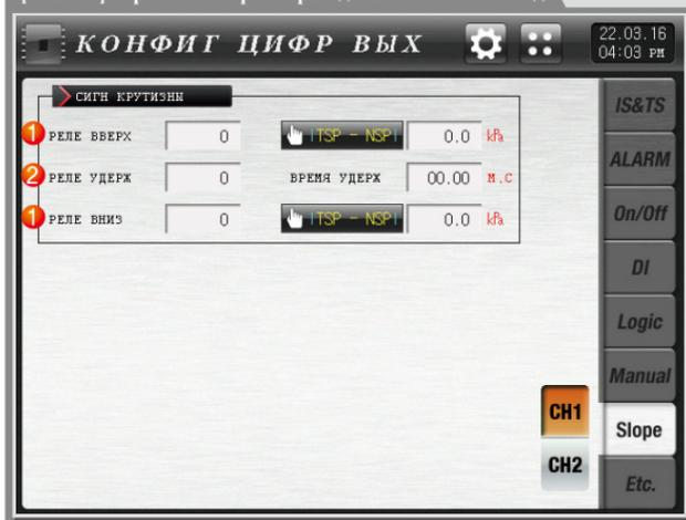
Сигнал реле ВВЕРХ : Установка номера реле для сигнала ВВЕРХ
