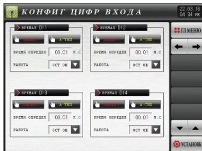
[Рис. 12-5] Экран №3 настройки функций цифрового входа (Канал 1)
