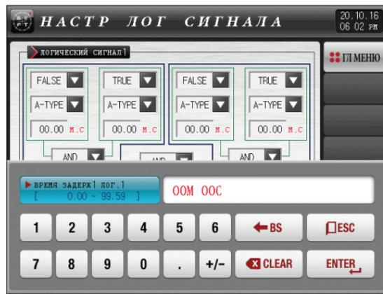
[Рис. 7-4] Экран настройки времени задержки логического сигнала
