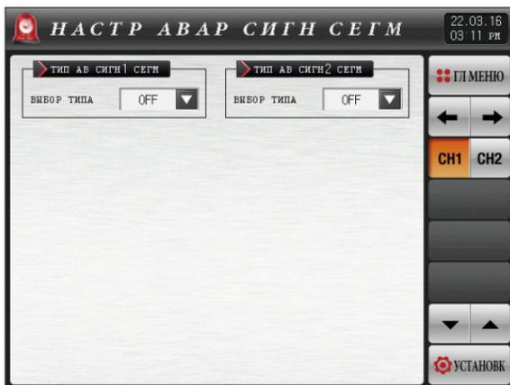
[Рис. 8-6] Экран выбора аварийного сигнала для сегмента (канал 1)
