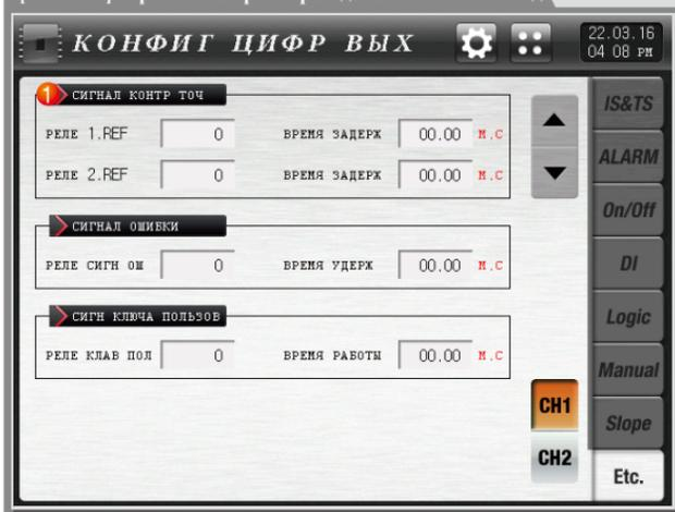
※ Рабочее реле канала 1 первого и второго сигнала охлаждения находится в положении ВКЛ после того, как внутренний сигнал (IS1) подан и длительность его работы (МИН.,СЕК) истекла. Для канала 2, он будет включен после того, как внутренний сигнал (IS1) подан и длительность его работы (МИН.,СЕК) истекла.
