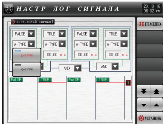
[Рис. 7-3] Экран настройки метода измерения логического сигнала.
