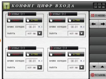
[Рис. 12-10] Экран №4 настройки функций цифрового входа (Канал 1)
