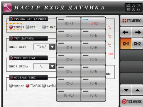
[Рис. 3-2] Экран выбора типа датчика
