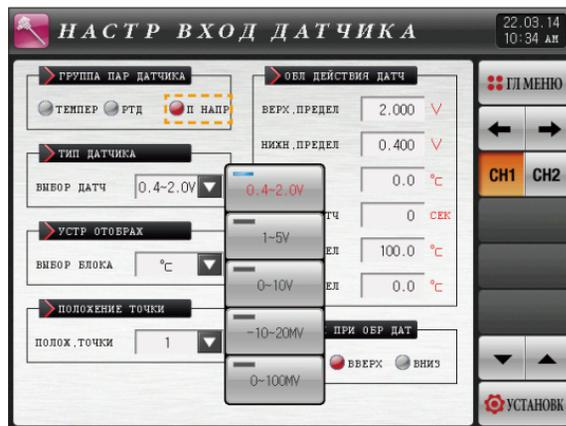
[Рис. 3-7] Экран выбора типа датчика DCV
