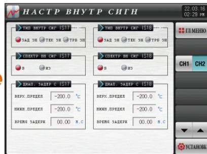
[Рис. 5-2] Экран №1 настройки внутреннего сигнала
