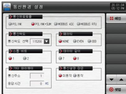
[Рис. 10-3] Экран настройки среды передачи данных (RS232C/485)
