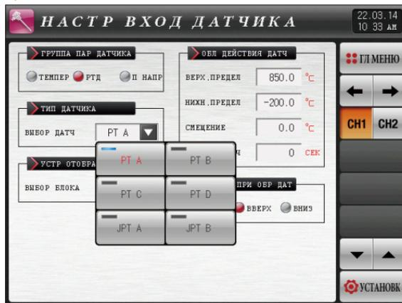
[Рис. 3-5] Экран выбора типа датчика RTD
