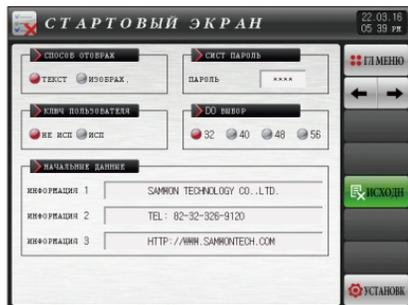
[Рис. 14-1] Экран с выбором текстового
