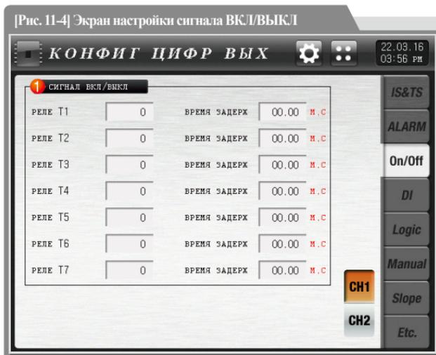
Установка номера реле для сигнала ВКЛ/ВЫКЛ, а также времени задержки
