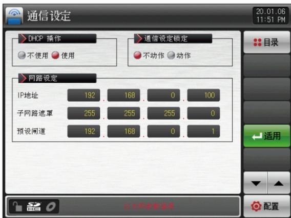
[Рис. 10-8] Экран настройки передачи данных при использовании DHCP
