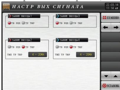
[Рис. 4-7] Экран выбора типа выхода OUT
