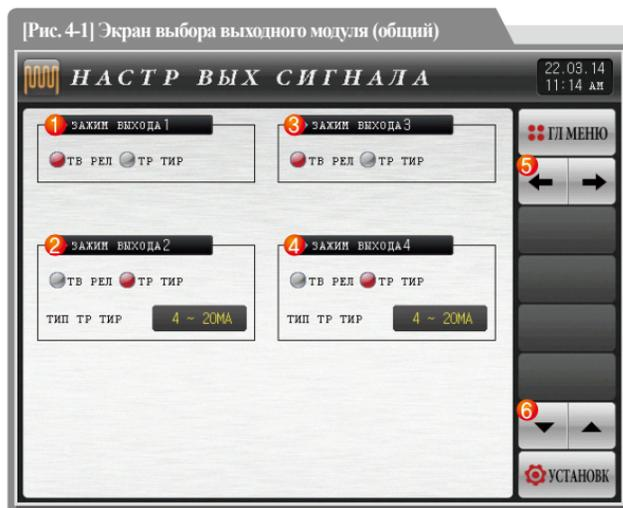
[Рис. 4-1] Экран выбора выходного модуля (общий)
