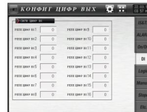
[Рис. 11-5] Экран настройки реле сигнала цифрового входа
