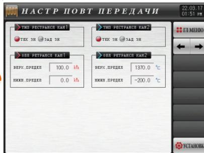
[Рис. 4-13] Экран настройки передающего выхода
