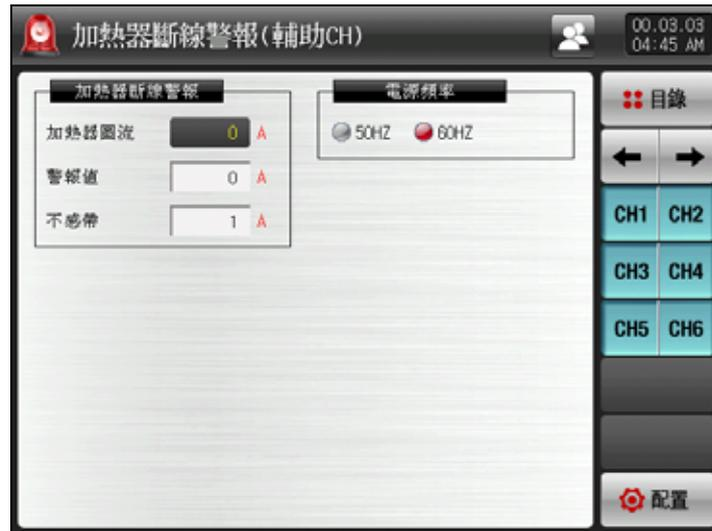
[图22-21] 加热器断线警报信号设定画面-2
