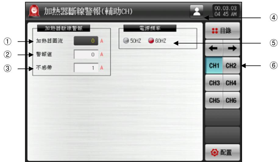
[图22-20]加热器断线警报信号设定画面-1
