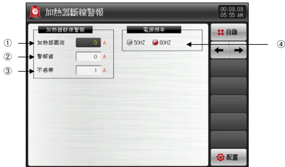
[图17-6]加热器断线警报信号设定画面
