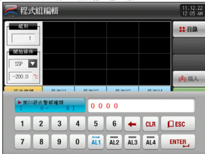
▶ 点击 **2** (分区PID)按钮, 就会显示可以设定分区PID的输入键。
