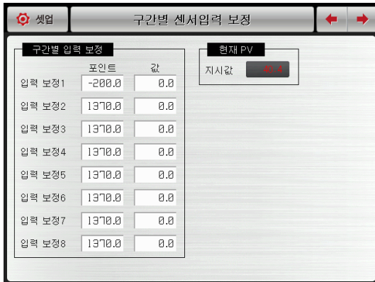
[그림 3-16] 구간별 센서 입력 보정화면
