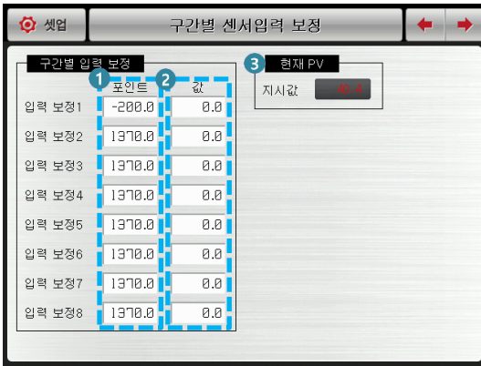
[그림 3-16] 구간별 센서 입력 보정화면
