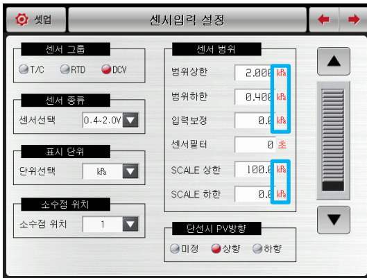
[그림 3-13] 표시단위 설정화면(kPa 선택인 경우)
