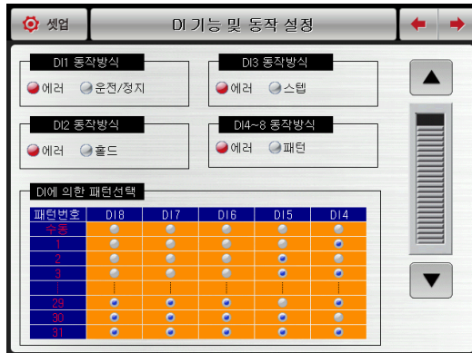
[그림 12-2] DI 기능 및 동작 설정 제 1 화면 #2
