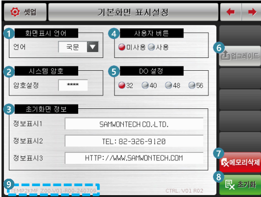
[그림 14-1] 기본화면 표시 설정 제 1 화면
