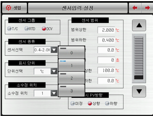
[그림 3-10] DCV 센서의 소수점 위치 선택화면
