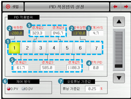
[그림 9-1] PID 적용범위 설정 제 1 화면 #1
