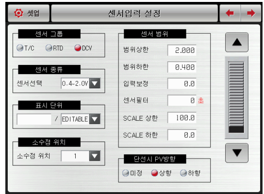
[그림 3-11] DCV 센서의 표시단위를 편집으로 선택화면
