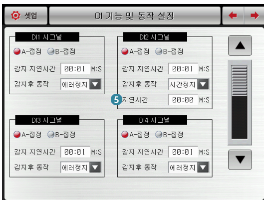
[그림 12-5] DI 기능 및 동작 설정 제 2 화면 #3
