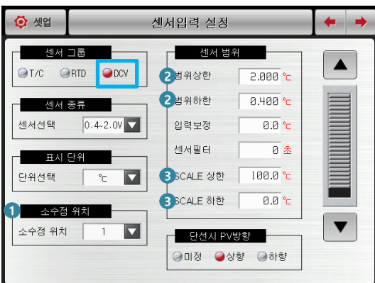
[그림 3-7] 센서입력 DCV 선택화면
