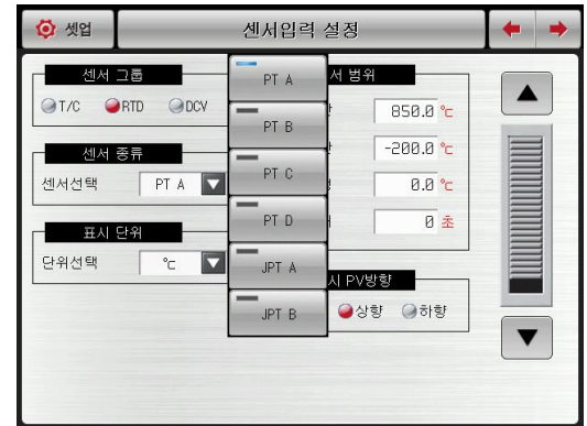
[그림 3-6] RTD 센서 종류 선택화면
