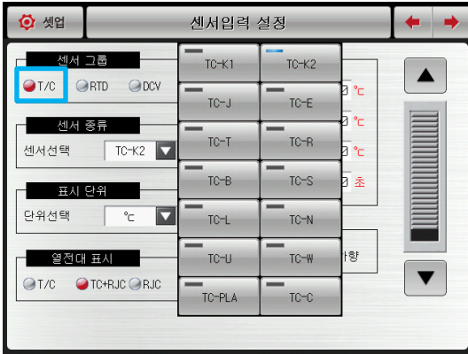
[그림 3-3] T/C의 센서 종류 선택화면
