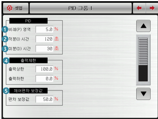
[그림 9-3] PID 그룹 설정화면 #1
