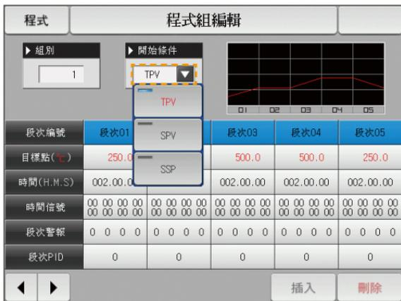
▲ 按“开始条件”键、显示可设定开始条件的输入键。
