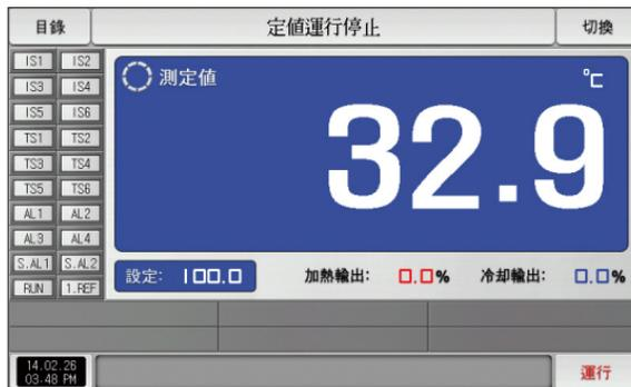
[图3-10]定值运行第1停止画面(加热·冷却)
