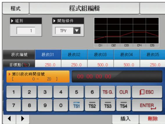
▲ 按  (时间信号) 键、显示可设定时间信号的输入键。按  键、可以设定 TS1 ~ TS8 的时间信号。
