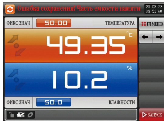
[Рис. 4-22] Экран отображения предупреждений о заполнении памяти
