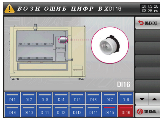
[Рис. 8-10] Экран для отображения ошибок DI по фотографиям
