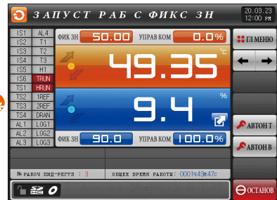
[Рис. 4-7] Экран ожидания в стационарном режиме №2 (Общий)
