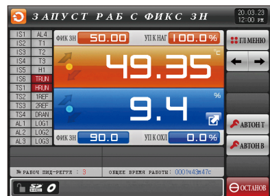
[Рис. 4-8] Экран ожидания в стационарном режиме №2 (Нагрев – Охлаждение)
