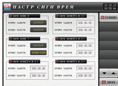
[Рис. 6-7] Настройка временного сигнала №1
