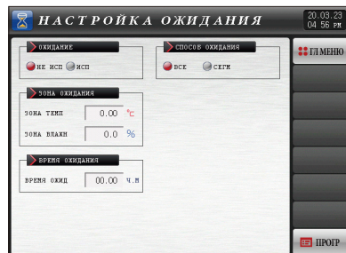
[Рис. 6-10] Экран настройки работы в режиме ожидания
