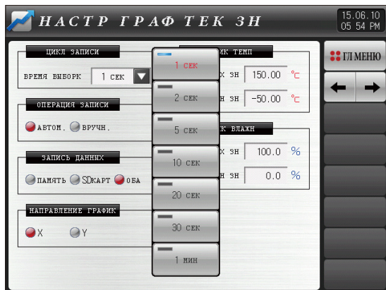
[Рис. 3-11] Время выборки экрана настройки цикла записи.
