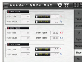
Рис. 11-8) Экран №2 настройки реле дополнительного выхода
