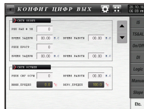
[Рис. 11-10] Экран №2 настройки реле дополнительного выхода
