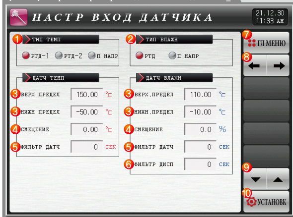
[Рис. 3-1] Настройки параметров входного сигнала – датчик PT_1
