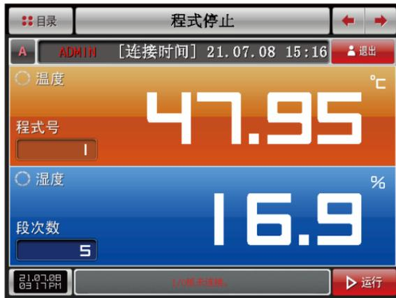
[图9-2]I/O板通信故障画面
