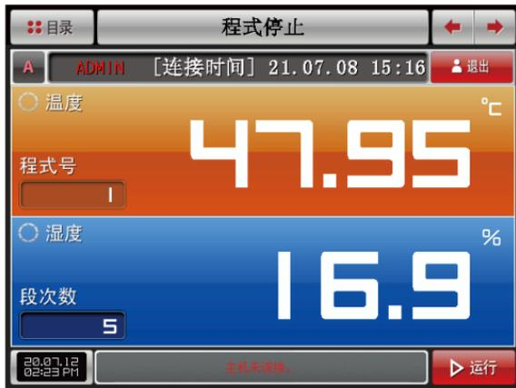
[图9-1]主机通信故障画面
